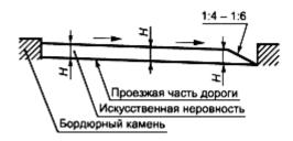
IV - при одностороннем поперечном уклоне проезжей части и наличии дождеприемного колодца в нижнем лотке с верховой стороны дороги на спуске у ИН (см. рисунок 2г).
