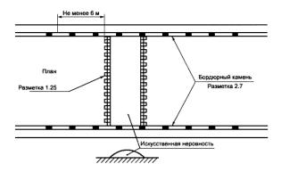
При необходимости устройства возвышающегося наземного пешеходного перехода, совмещенного с ИН, нанесение линии разметки наносят в соответствии с рисунком 5.
